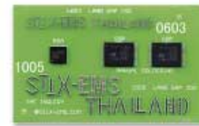
微細チップ部品のサイズ比較。1005(1.0×0.5mm)と0603(0.6×0.3mm) SIIX EMS THAILAND "の文字の1点1点がチップ部品で構成される。
